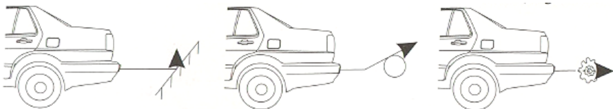
obr. 3 Objekty, které mohou způsobit chybnou detekci
